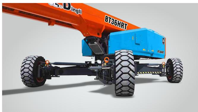
Brandneue Technologie zur Achsausbreitung an Ort und Stelle mit einem Schlüssel Weltweiter Patentschutz
